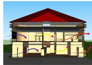
Gambar 23 Skema aliran udara kamar hotel
