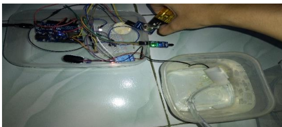
Gambar 7. Pengujian Pada Sensor MQ2
