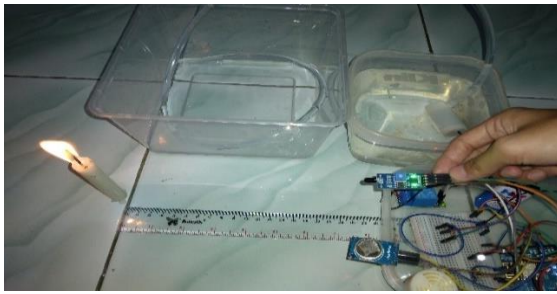
Gambar 6. Pengujian Pada Flame Sensor
