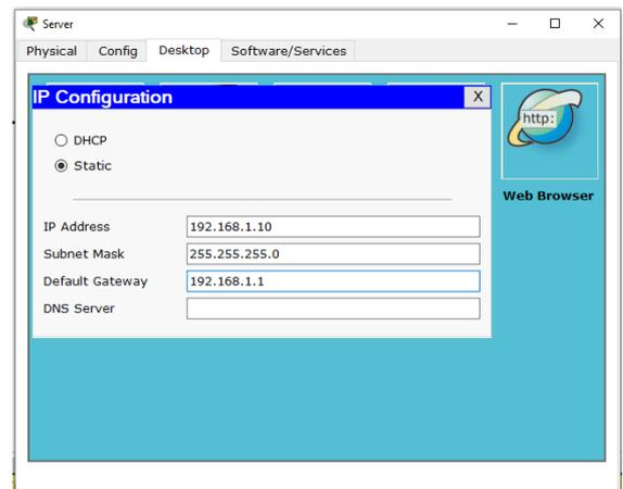
**Gambar 4. Konfigurasi IP dan Gateway pada server**
