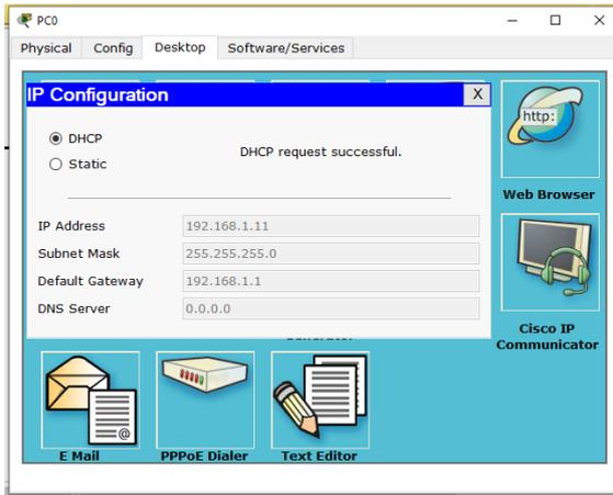
Gambar 6. Konfigurasi IP Address PC0
