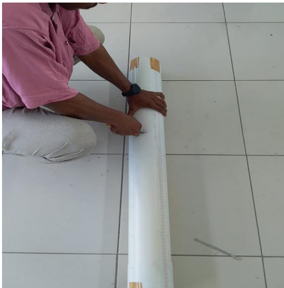
Gambar 4. Proses pembuatan lubang pada PVC ukuran 3 inch
