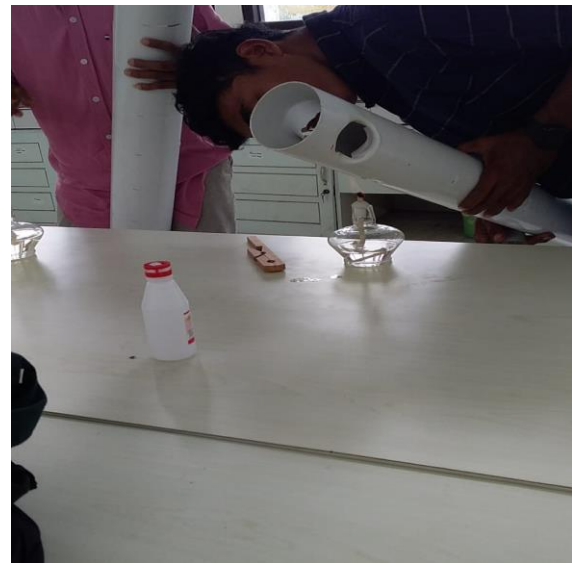
Gambar 4. Proses pembuatan lubang pada PVC ukuran 3 inch
