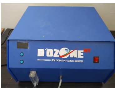
Gambar 2. Ozon diproduksi melalui teknologi plasma dengan bahan baku udara maupun oksigen.
