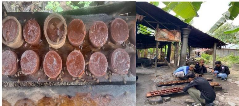
Gambar 4. Proses pelepasan dari cetakan dan pendinginan
