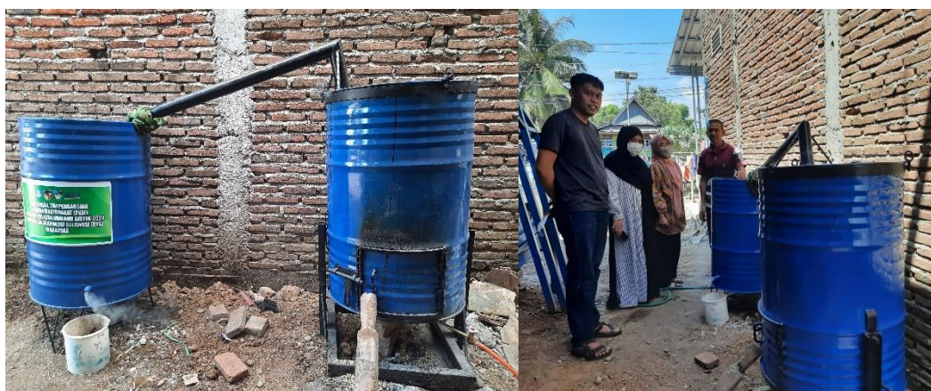
Gambar 4. Hasil modifikasi drum pirolisis menjadi alat pembuatan biochar arang sekam
