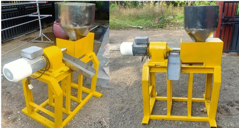
Gambar 4. Mesin Rice Bran Oil Generasi kedua kapasitas 100kg
