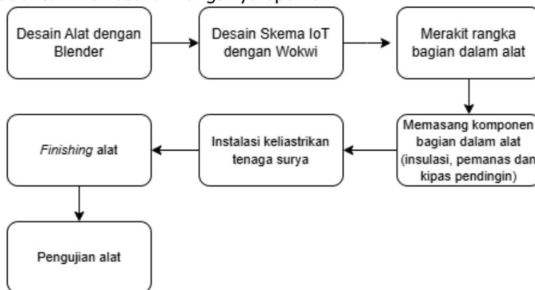
Gambar 1. Alur pembuatan alat pengering biji kakao
