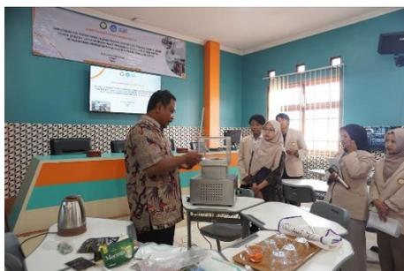
Gambar 1.2 Uji Coba Penggunaan Alat Pengering Fluidized Bed Dryer
