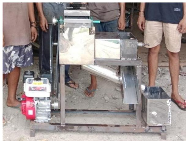
Gambar 4. Alat Mesin Pengupas Sabut Kelapa.
